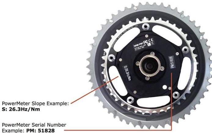
Il valore dello slope del PowerMeter e' scritto nei seguenti punti:
