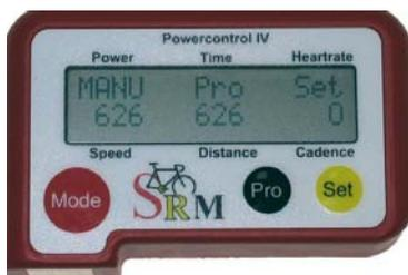
Accendere il PowerMeter ruotando le pedivelle in senso orario ed attendere qualche secondo fino a quando il valore più a destra si e' stabilizzato.
